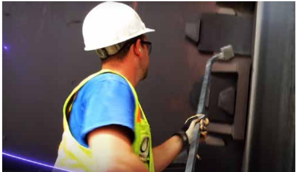
*Die Graphitblock-Schmiervorrichtung für Easy Bar-Blöcke ist 1,25 m lang und dient der besseren Sicherheit und schnelleren Anwendung.*
